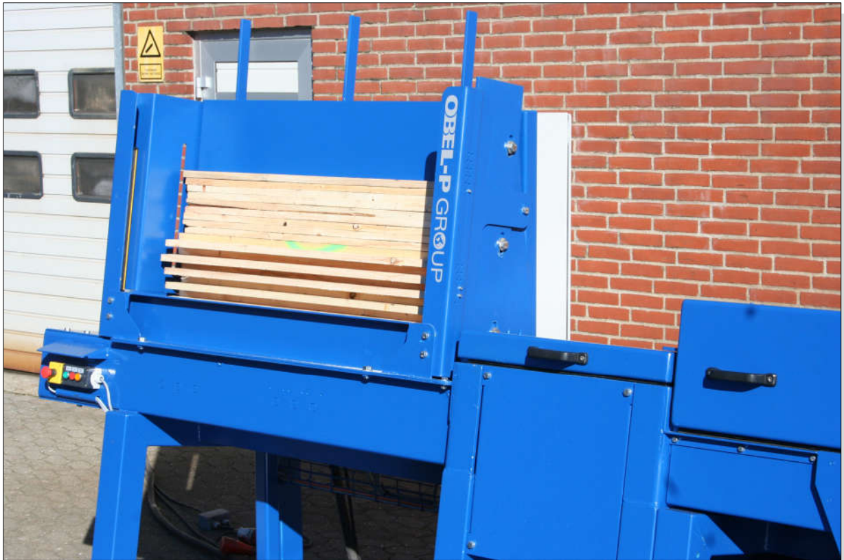
Magazin für die Brettzuführung. Unten die Einzugs-kette, ausgestattet mit Stahlmitnehmern
